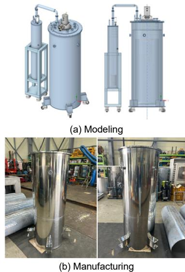
Fig. 2. LH<sub>2</sub> liquefier
