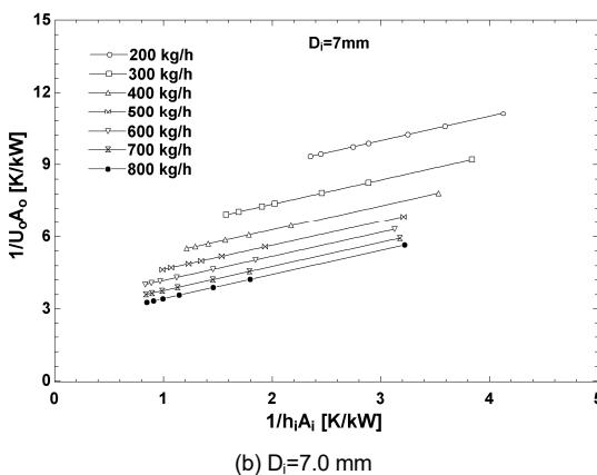
Fig. 5. Wilson plot (a)  $D_i=8.0 \text{ mm}$ , (b)  $D_i=7.0 \text{ mm}$
